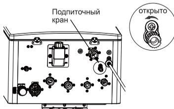
4.2. Когда показания стрелки манометра окажется в пределах 1,2-2 бар, закройте подпиточный кран.
