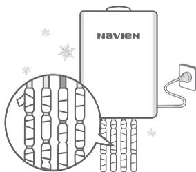
**Сливайте воду из контура отопления и контура горячего водоснабжения, если котёл не будет использоваться в течение длительного периода.**
